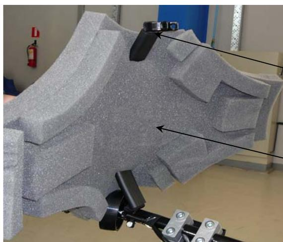
б) проденьте держатель поз. 1 через отверстия в наполнителе поз. 4, как показано на рисунке
