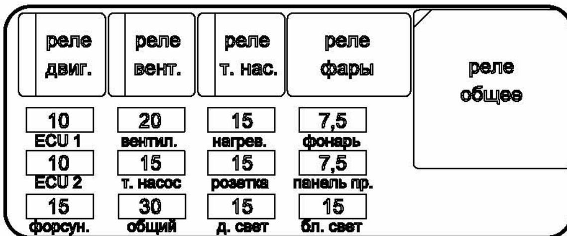
Рисунок 25 - расположение реле и предохранителей в блоке
